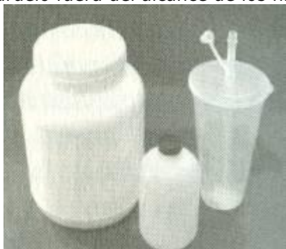
Se pueden encontrar en Internet recipientes de polietileno de alta densidad adecuados Fig. 137 Recipientes que no rezuman
