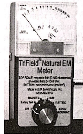
El medidor de campo electromagnético detecta cambios locales en el campo magnético de la tierra
